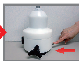
⑤ 裏面の真空解除ボタンを押してビンを取り出します
