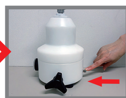
⑤裏面の真空解除ボタンを押して ビンを取り出します
