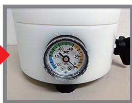
③真空ゲージで真空圧を確認
