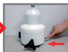
⑤裏面の真空解除ボタンを押して内部からビンを取り出します
